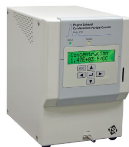
凝縮粒子カウンター CPC3790A-10 D_{50}=10\text{nm}
