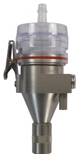
respirable粉じん用サイクロン MesaLab社 GK2.69 D50: 4 \mu m @4.2 L/min
