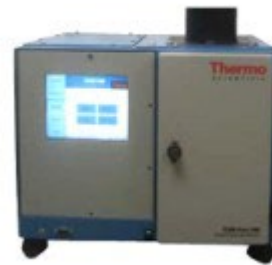
TEOM 1405 D PM 10 , PM 2.5 , PM 10-2.5 同時計測
