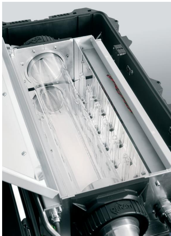
DOFRの酸化チャンバーは透明なガラス製で、周囲に12個のUVCランプ(254 nm)が配置されています。
