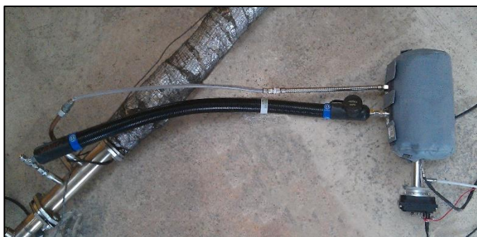
排ガス計測で使用されるPPS-DTの写真①
