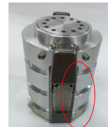
ホルダ留め具は2段+バックアップ用に設計されている
