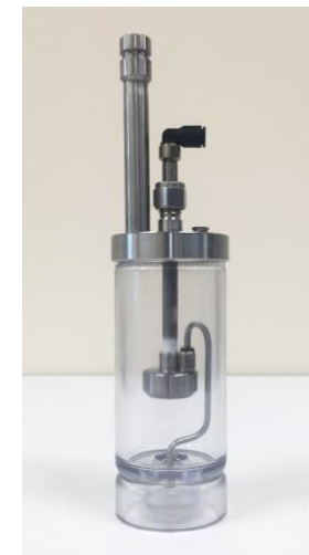
ブロースタインアトマイザー (BLAM) 発生粒子サイズ: 約0.1~8 \mu\text{m}
