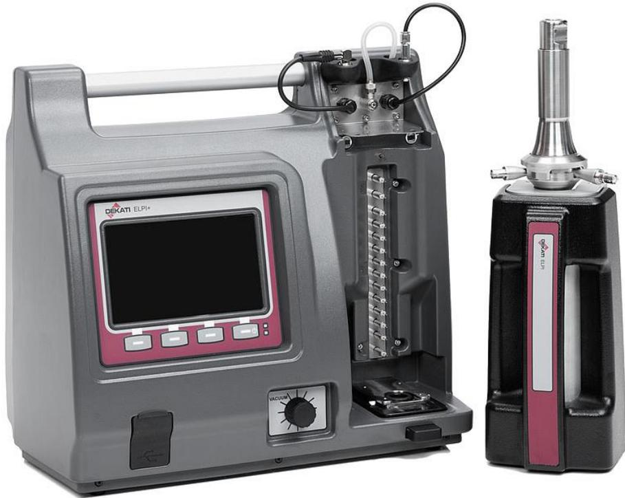
6nm～10 $\mu$ mを13CH(HRモデルは500CH)で粒径分布濃度測定が可能
