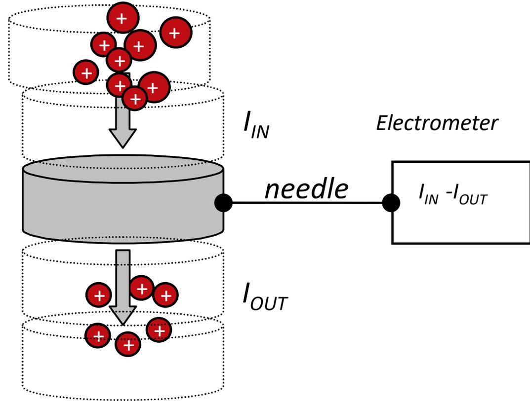
各ステージ間は完全に絶縁されており、独立したファラデーケージとなっている。粒子の材質に対する依存性はなく、運ばれた粒子に対する電流が直ちに計測される。
