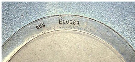
サポートリング上にナンバリング/バーコード付 フィルターの個体識別や秤量時各種データ（秤量データ、環境データ） の一元管理が必要な場合ご相談下さい。
