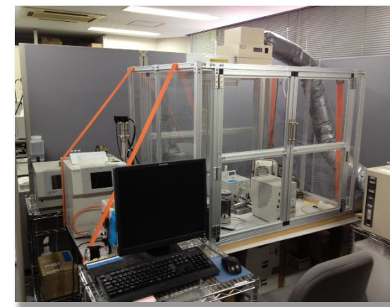
東京ダイレック社内のCPC校正作業スペース
