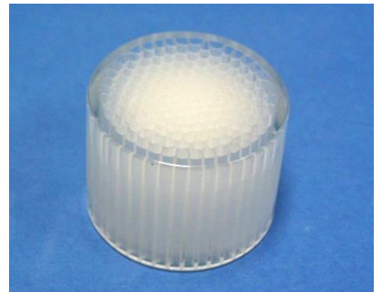
ハーバード大学公衆衛生学部により開発された47mmハニカムデニューダー
