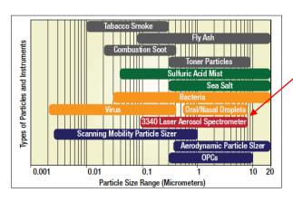
左図は、代表的なエアロゾルのサイズと一般的 な測定器の持つ、粒子径対応範囲を示したもの です。
