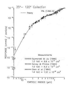
粒子散乱光の応答特性 X軸:粒子半径 Y軸:散乱光信号
