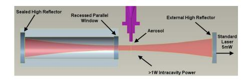
パテントの光学系デザイン(Intracavity Laser) \*US Patents Numbers; 5, 907, 575; 7, 079, 243; 7, 295, 58
