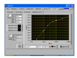
PSL粒子 100nm、107nm、123nmの測定例 僅かな粒子径の差も識別出来ている事を示しています
