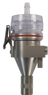
respirable粉じん用サイクロン MesaLab社 GK2.69 D50: 4 μm @4.2 L/min
