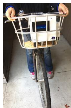
Figure 4. 自転車を用いた移動車両計測例
