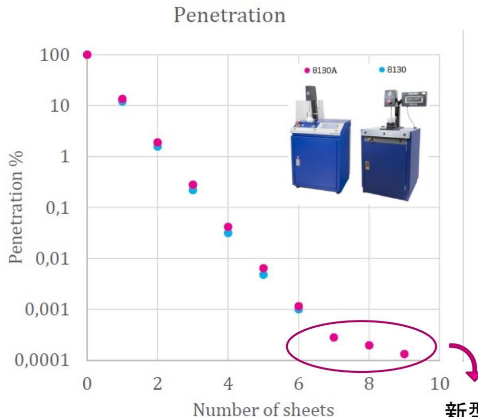
新型AFT8130Aは捕集効率99.9999% (透過率0.0001%)まで測定可能
