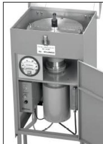
上の写真は、AH-600アンダーセンハイボリウム サンプリング ヘッドを、フローコントローラー付ハイボリウムサンプラーに組み込んだ例です。
