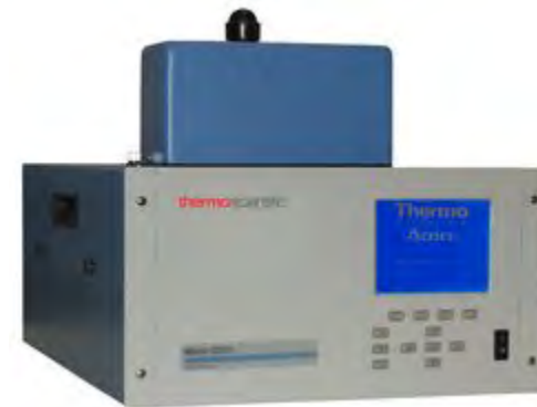
ハイブリッドモニター SHARP5030i ベータ線吸収・光散乱法による相互補正 PM 10 , PM 2.5 を同時測定
