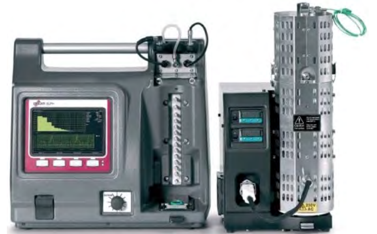
HT-ELPI®+ 180°Cまで加熱可能 高温のエアロゾルを ダイレクト捕集
